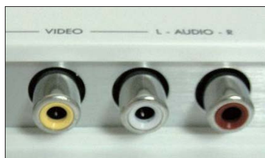
コンポジット端子（ピンプラグ） ピンプラグの黄→映像 赤（R：右）と白（L：左）→音声
