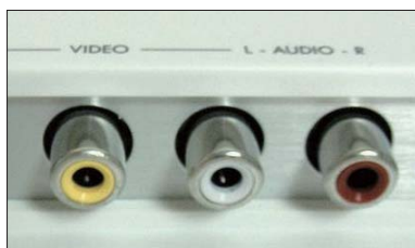
図 5-9 (16) コンポジット端子 (ピンプラグ) ピンプラグの黄→映像 赤 (R : 右) と白 (L : 左) →音声
