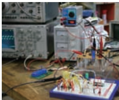
試作したリモコンカーとその制御システム（Webカメラで撮影した画像をパソコンで処理して位置を検出し、赤外線で操縦して目的地に到達します）
