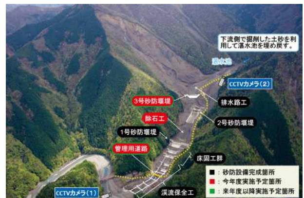
図 4. 国土交通省の砂防堰堤計画 ( https://www.kkr.mlit.go.jp/kiisankei/map/3.html 2021 年 2 月 3 日確認)。
